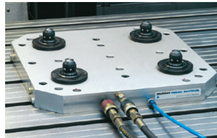
Maschinentisch Grundplatte mit 4 Einzugs-elementen
