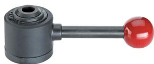
精實的夾持元件可以在推和拉的夾持應變之間轉換，取決於產品型號。行程為 10 mm。在 2 mm 的短固夾行程內，可自我鎖附於任何位置。可容許的最大固夾力道為 4.9 kN。
