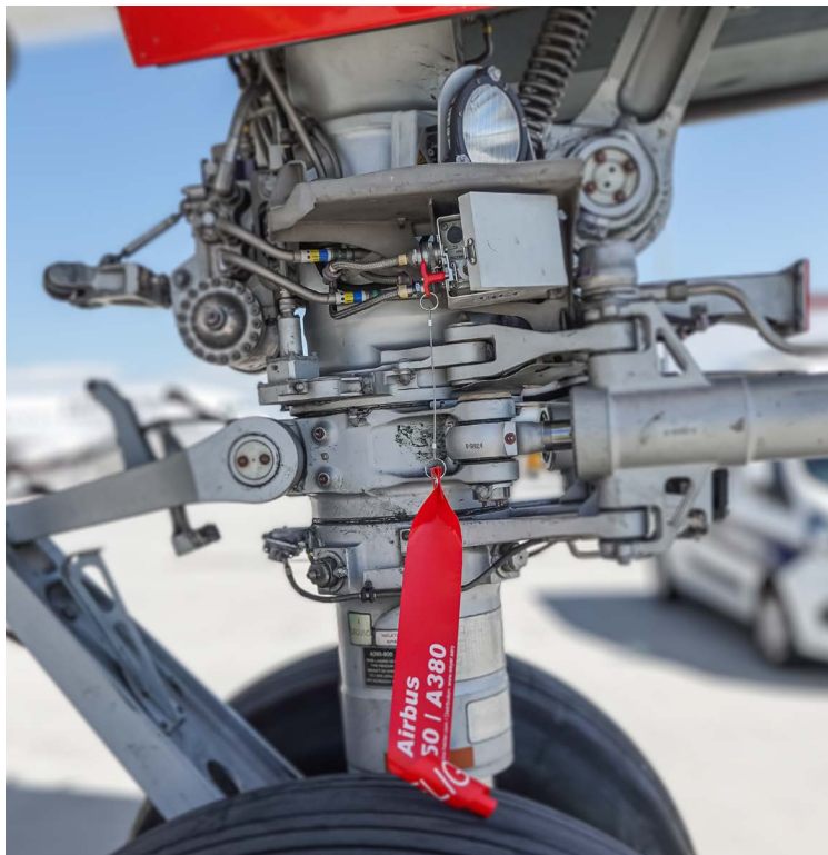
Eine Anwendung finden Kugelsperbolzen beispielsweise als sog. Gear Pin oder Steering Bypass Pin beim Pushback.
