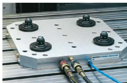
Stół maszyny: Płyta bazowa z 4 elementami łączącymi
