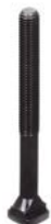
EH 23030. Śruby do wpustów teowych DIN 787 do M12 jakość 10.9 od M14 jakość 8.8
