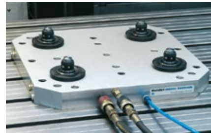
4つのクランプ・エレメントを持った、マシンテーブル上のベース・プレート
