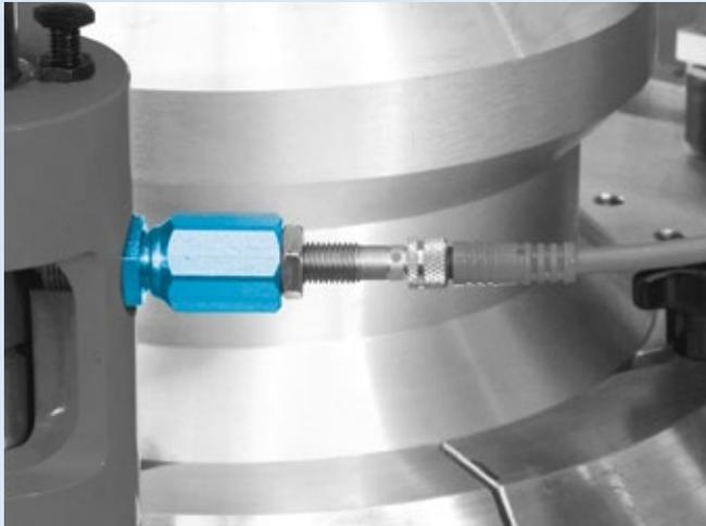
位置検出を目的とするセンシング・エレメントで市販の近接センサーを利用しています。図は細目ネジを使用したコンパクトな構成のモデルです。
