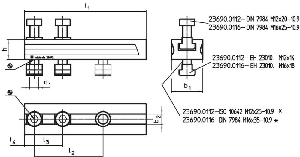
\* このアダプターを複数積み上げて使う場合には、固定用ボルトISO 10642またはDIN 7984を寸法hの分（使用個数に応じて）長いものに交換してください。
