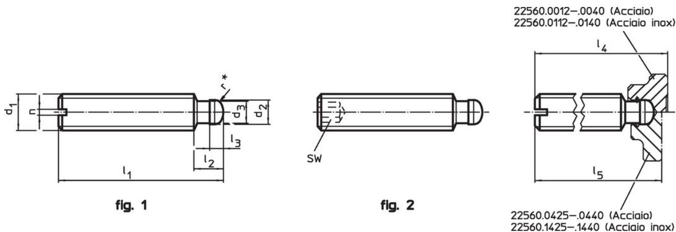
\* per facilitare il montaggio la DIN 6332 è dotata della raggiatura r
