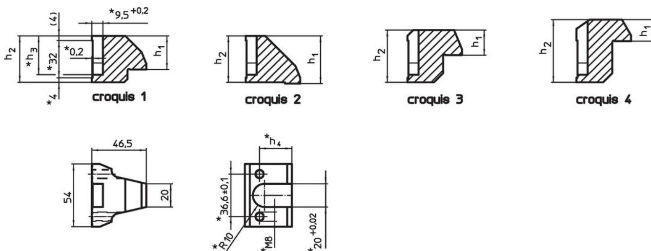
\* Respecter les dimensions et spécifications de matière lors de la réalisation mâchoires de serrage.
