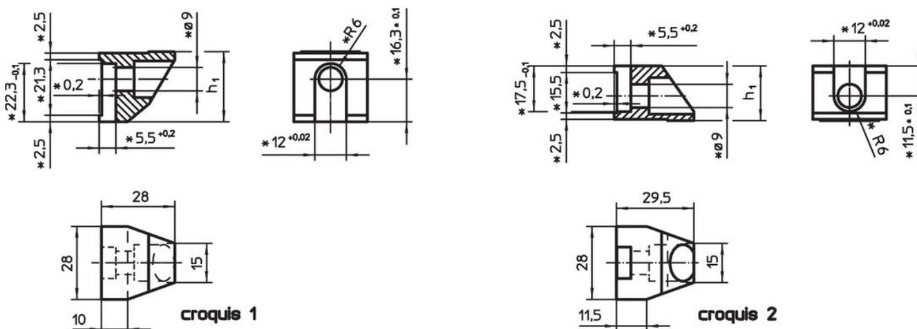
\* Respecter les dimensions et spécifications de matière lors de la réalisation mâchoires de serrage.
