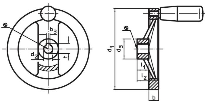
L'orientation de la rainure de clavette peut être différente de celle représentée sur le dessin.
