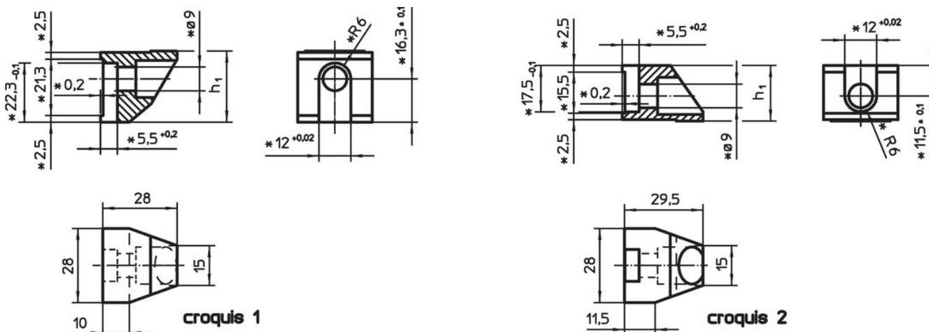
\* Respecter les dimensions et spécifications de matière lors de la réalisation mâchoires de serrage.
