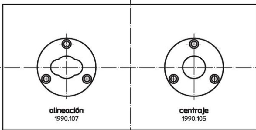
Posición de montaje de los anillos conectores
