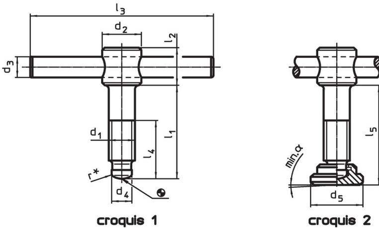
\* para facilidad de montaje del DIN 6304 se ha completado con el radio r
