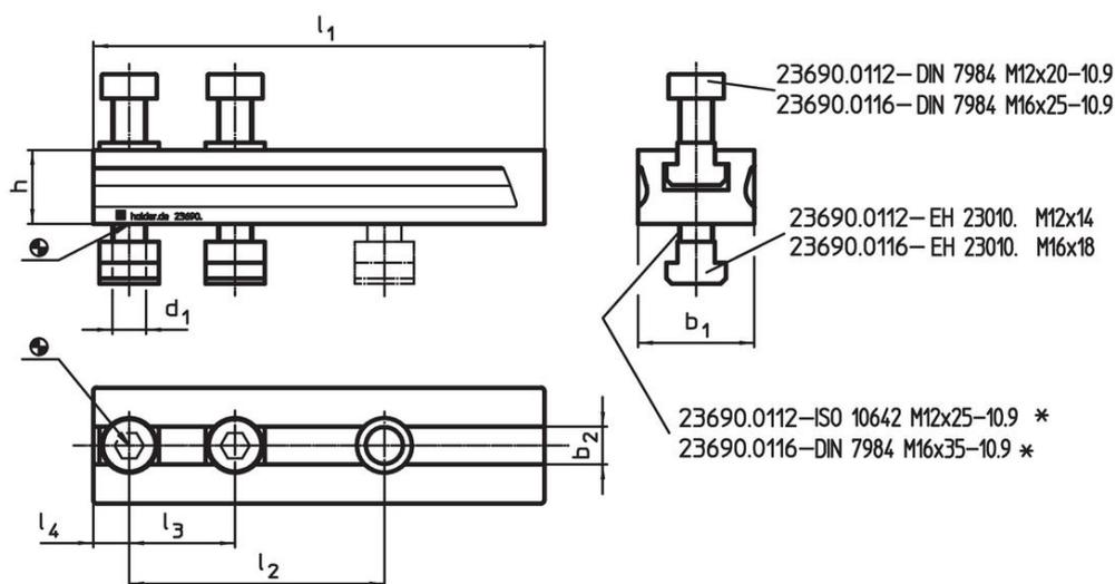
\* Cuando en el montaje se utilicen más adaptadores de altura, los tornillos ISO 10642 o DIN 7984 deben reemplazarse por tornillos de longitud aumentada de la cota h.
