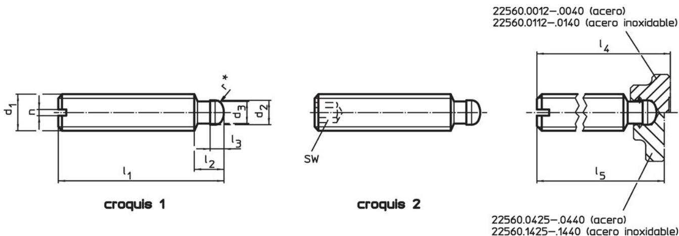
\* para facilidad de montaje del DIN 6332 se ha completado con el radio r
