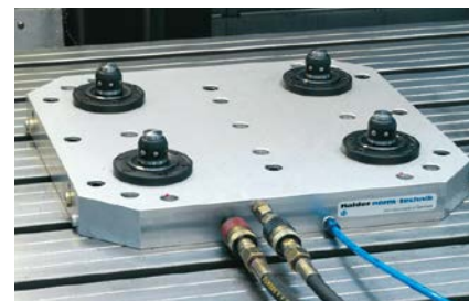
Mesa de mecanizado: Plato de fijación con 4 elementos de conexión
