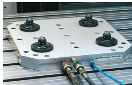
Základová deska se 4 upínacími prvky na pracovním stole stroje
