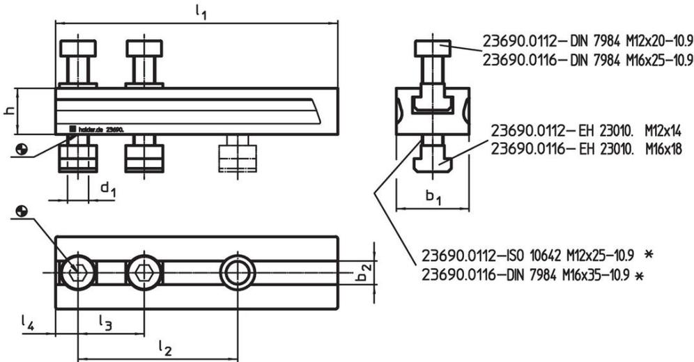
当使用更多的高度适配器时，ISO 10642 或 DIN 7984 的螺丝必须被换成加长形 (尺寸 h) 的螺丝
