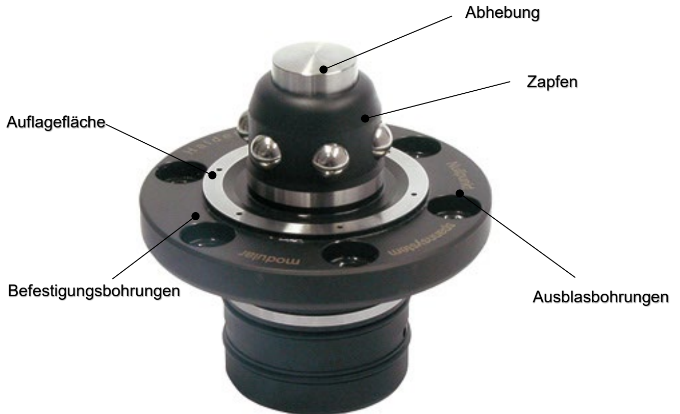
Abb. - Einzuselement hydraulisch, doppelt wirkend
