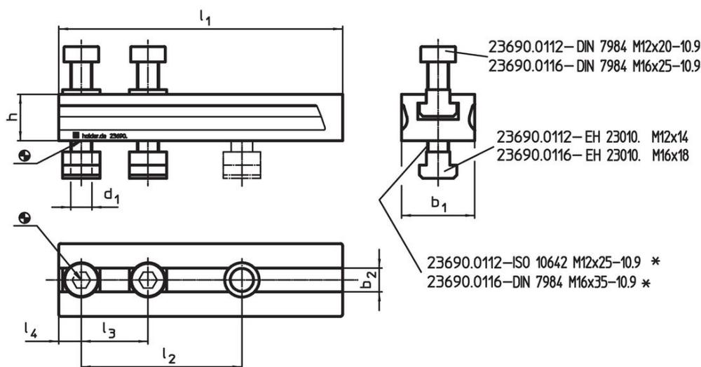
\* Beim Aufbau mehrerer Höhenadapter sind die Befestigungsschrauben ISO 10642 bzw. DIN 7984 durch um das Maß  $h$  verlängerte Schrauben zu ersetzen.
